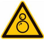
**Einzuggefahr** im Bereich der Vorzugwalze für Haare, Schmuck, Krawatten, Kleider usw.
