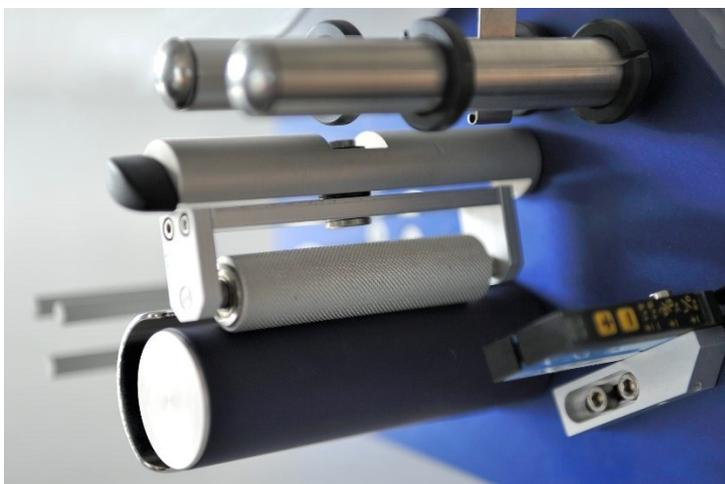
Das Trägerpapier gemäss folgender Abbildung in den Aufwickler einlegen. Das Trägerpapier wird danach automatisch aufgewickelt.
